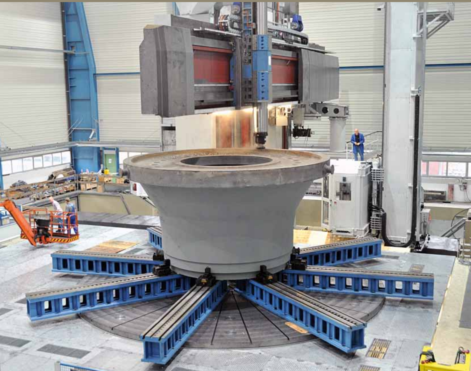
Carousel machining of a grinding bowl in the machining center of Siempelkamp Maschinen- und Anlagenbau
