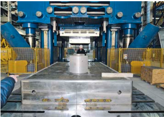
Oben links und rechts: Stauchtests mit Aluminiumingots; unten links und rechts: Exzentrizitätstest
