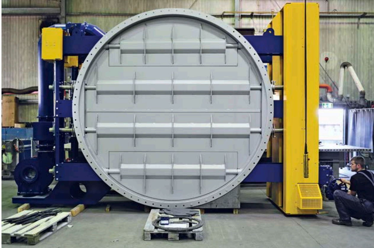
Doppelabsperrklappe NW 3150 mit Sperrgasgebläse und pneumatischen Anschlüssen
