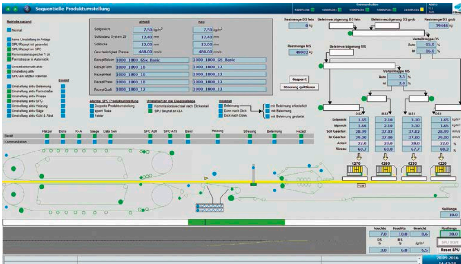
Visualisierung: Als grüner durchlaufender Balken (unten im Bild) sind der Umstellkeil und die Änderung im Gewicht erkennbar
