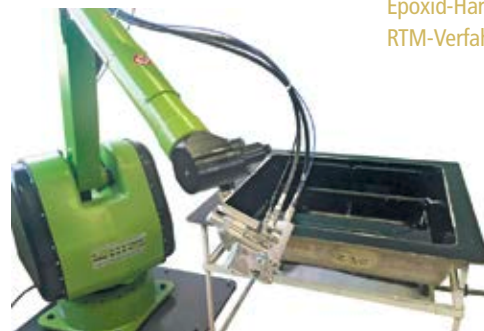
Gelcoatspritzen mit Roboter
