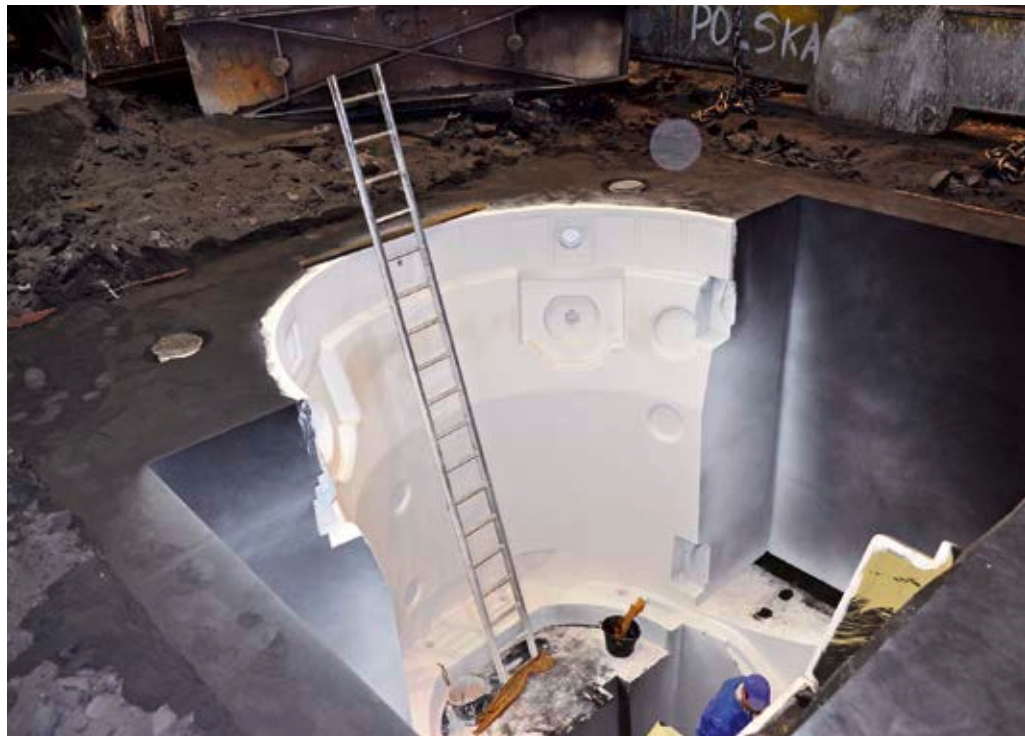
Formherstellung für Adwen-Maschinengehäuse in der Gießerei
