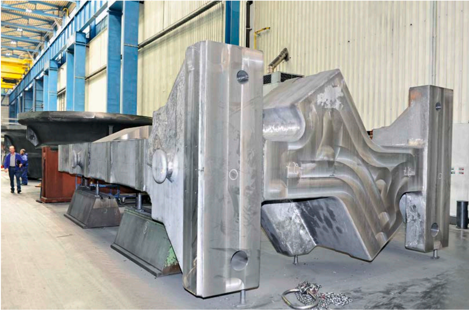
Pressenrahmen für eine Schmiedepresse in der Maschinenfabrik
