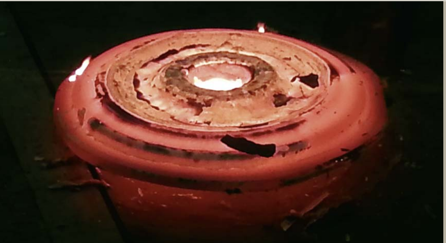
Produkt aus der Gesenkschmiedepresse zur Weiterverarbeitung auf der Ringwalze (Erprobungsphase)
