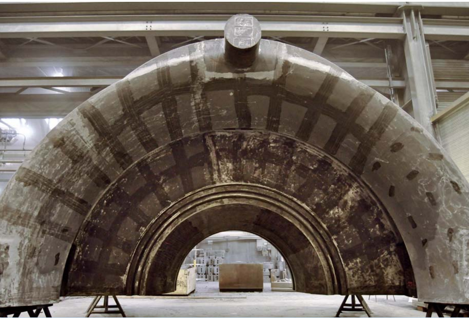
Ein Dampfturbinengehäuseteil, ca. 55 t, bei der Ultraschallvorprüfung
