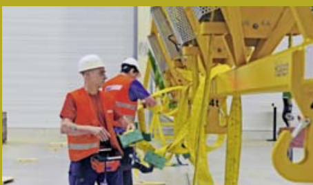
Die Kranbediener überprüfen die sichere Befestigung
