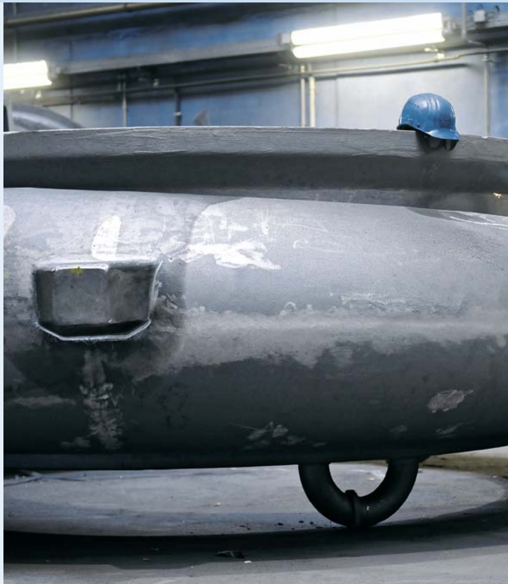
Ein Spiralgehäuse, 25 t, beim Putzen
