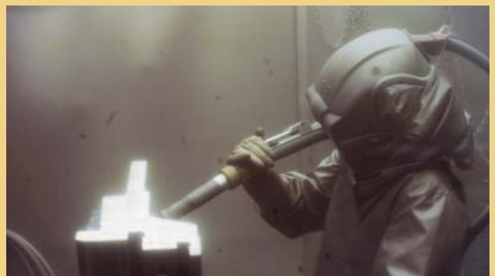
In der Trockenbox strahlt ein Mitarbeiter ein Metallteil ab
