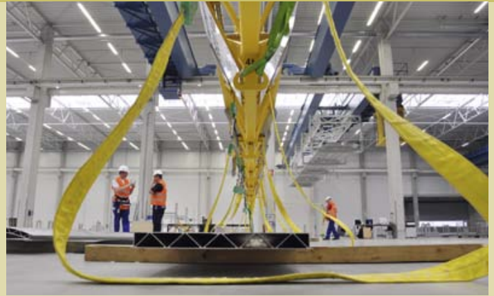
Langteile mit bis zu 28 m Länge können am Kran ganz einfach bewegt werden
