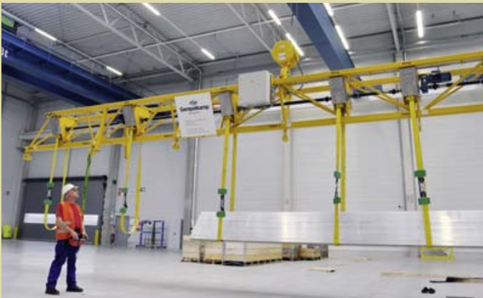
Das Drehen um die Längsachse des Aluminiumteils ist keine Herausforderung für die neue Siempelkamp-Krananlage
