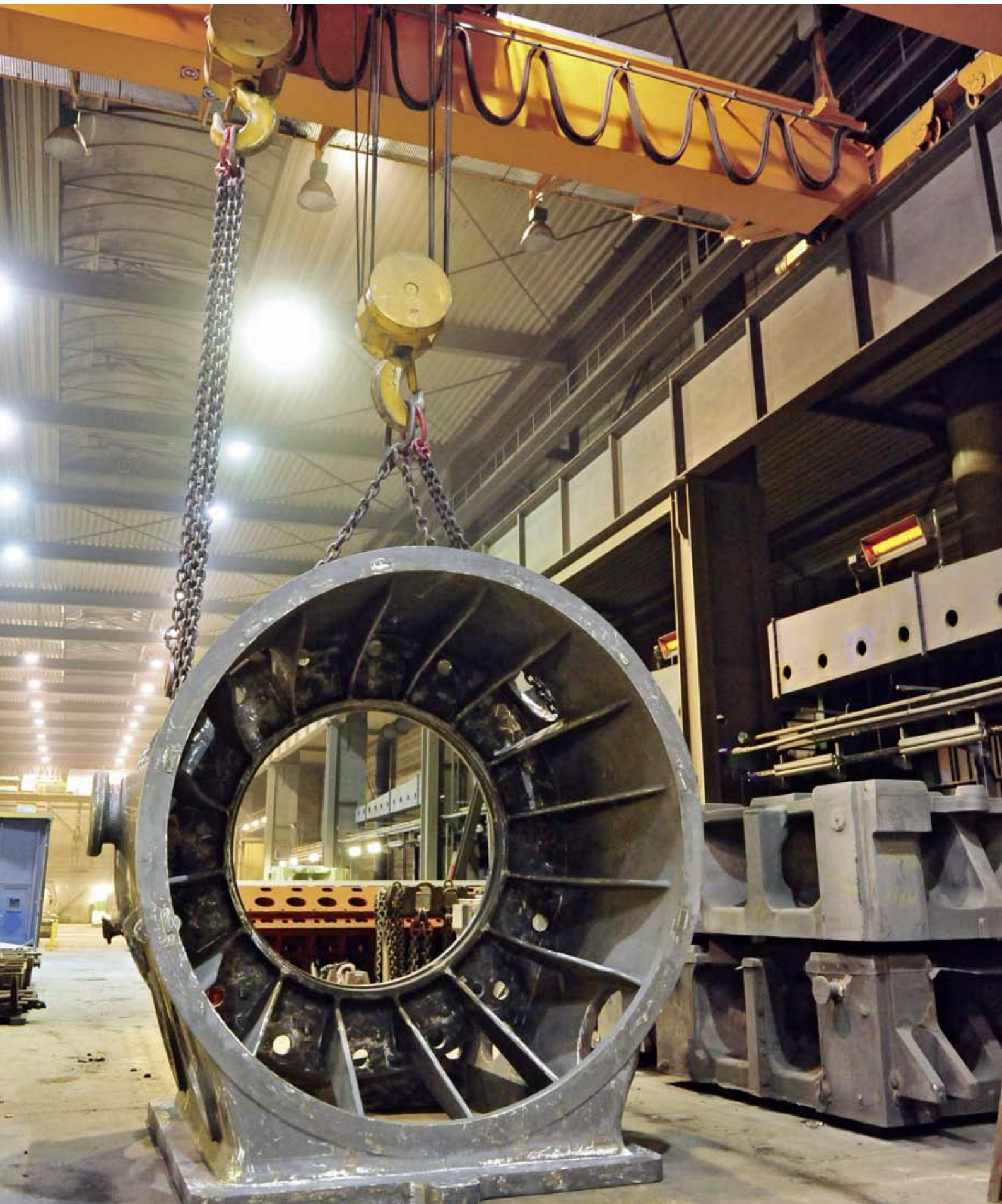
Putzarbeit: ein Gehäuse für eine Unterwasserturbine
