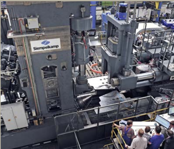
Ringwalze während der Erprobung bei Siempelkamp in Krefeld
