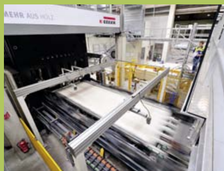
Eine Charge läuft in die Presse
