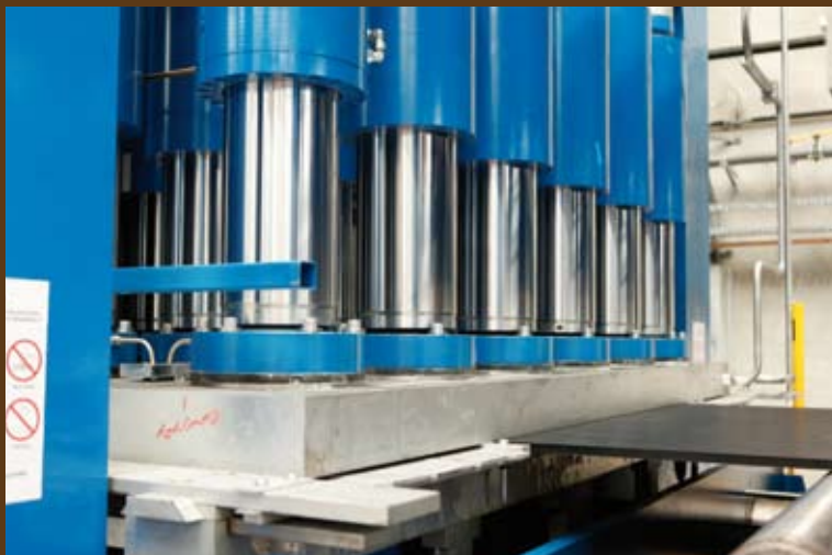
Presseneinlauf mit 6 Zylindern in der Breite
