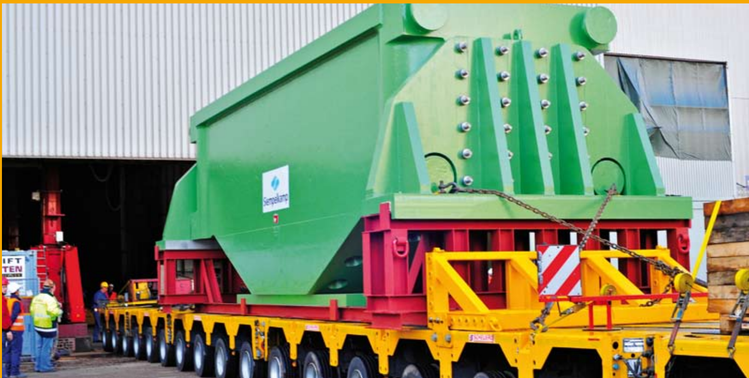
Anlieferung des Unterholms auf der Baustelle
