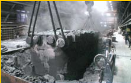
Ausheben des fertigen Teils
