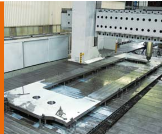
Rahmenblech der Kompaktierpresse auf der Schiess
