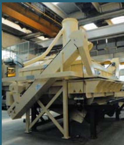
Reinigungsanlage für Hackschnitzel
