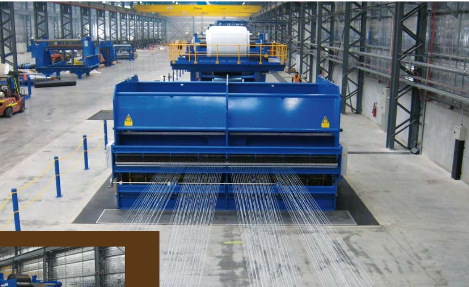
Einlauf vom Seilabwickelgestell in die Seilspanstation
