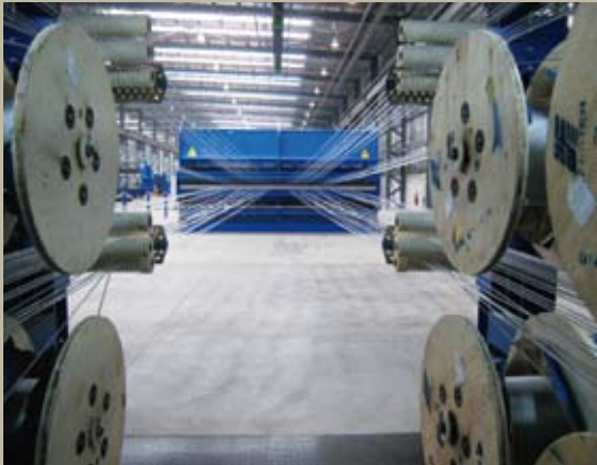
Auslauf Seilspannstation mit Kamm und Umlenkrollen
