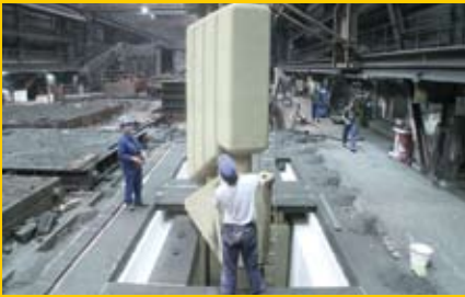
Einsetzen der Formteile
