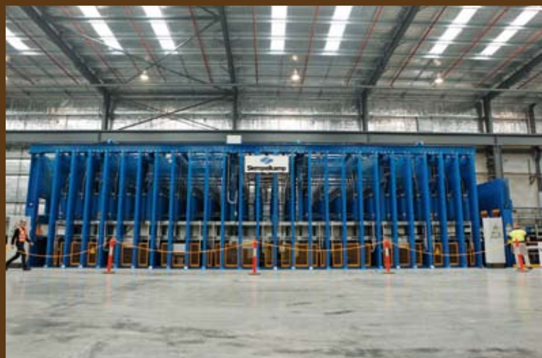
Vulkanisierpresse 3.200 mm x 18.480 mm; 156 Zylinder; 25.000 t
