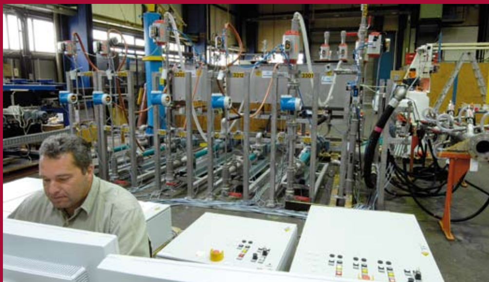
Test einer kompletten Beileimung für eine MDF-Anlage
