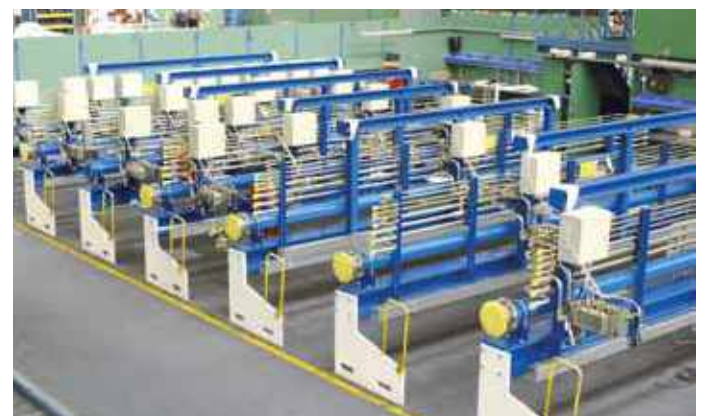
Hydraulische Funktionsträger mit 6 m Länge
