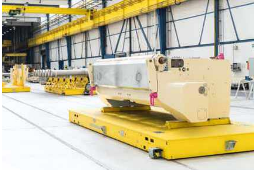
Unterer flexibler Einlaufkopf auf einem Schwerlastrollwagen mit RundSchienen®-Technologie
