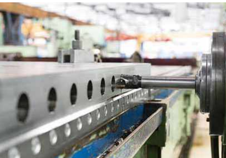
..... Tieflochbohren der Kanäle einer Heizplatte .....
