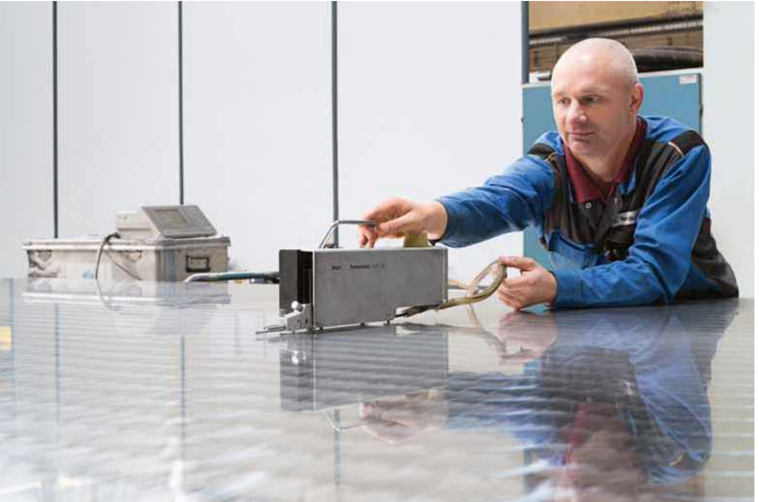
Oberflächenprüfung einer Heizplatte
